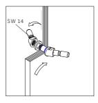
Unterlegscheiben und Schutzhülse auf Spezialschraube aufstecken und mit gegenüberliegender Spezialschraube paarweise verschrauben und ausrichten.
